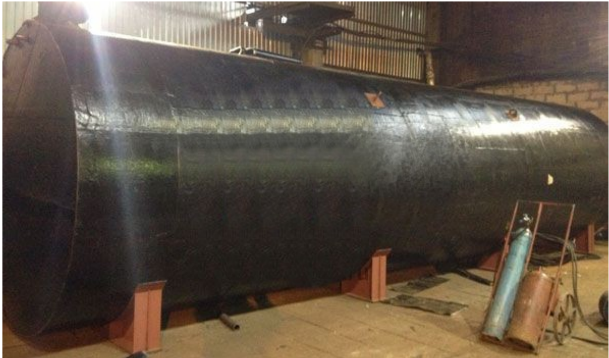
Примеры емкостей подземных дренажных, изготовленных МЗРО:
