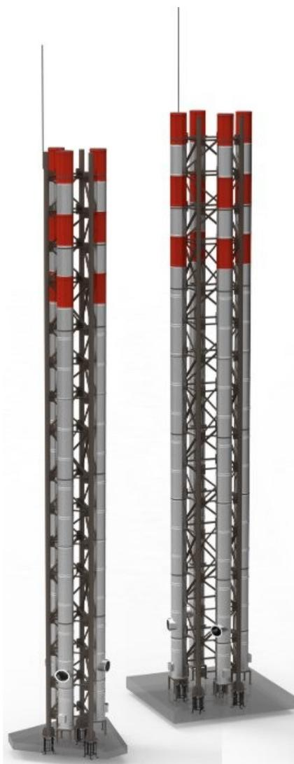
Труба дымовая мачтовая представляет собой отдельно стоящую конструкцию. Крепление к основанию производится посредством залитой в фундамент анкерной корзинки. Несущей конструкцией является колонна, к которой при помощи хомутов крепятся газоходные стволы.
