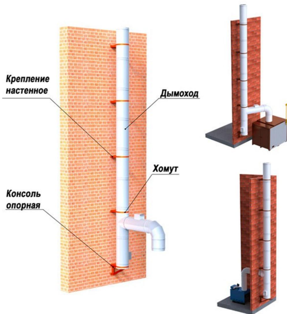
Труба дымовая фасадная применяется вместе с пристроенной либо встроенной котельной в случае наличия возможности крепления трубы к фасаду здания. Такой вид является наименее затратным, поскольку не требует устройства фундамента и несущей части.
