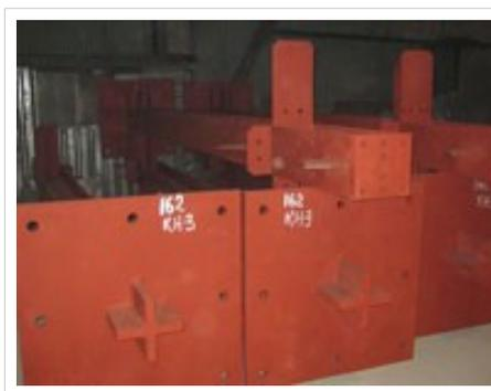
Сборка колонн производится на специальных стапелях для наиболее полного соответствия заданным геометрическим размерам. После сборки (в том числе сварных операций) производится фрезеровка плоскостей опорных плит, что позволяет уменьшить трудозатраты при монтаже.
